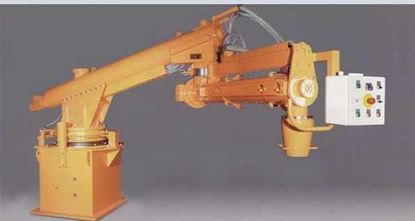
Производство литья на автоматической формовочной линии по технологии ХТС (холодно твердеющих смесей) по методу фуран-процесса. Указанная система включает следующие компоненты: фурановую смолу, песчаный наполнитель и катализатор. Основным преимуществом применения указанного процесса является высокая производительность при изготовлении форм и относительно невысокий расход связующих (до 1% от общей массы формовочной смеси).
