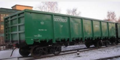
Полувагон четырехосный цельнометаллический с глухими торцевыми стенами модель **12-9796**
