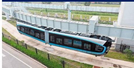
В Ухане — представлен поезд Optics Valley Photon подвесной монорельсовой линии. Двухвагонный сочлененный поезд вместимостью до 200 чел. рассчитан на движение со скоростью до 70 км/ч. Также возможна работа по системе многих единиц — до шести вагонов в поезде.
