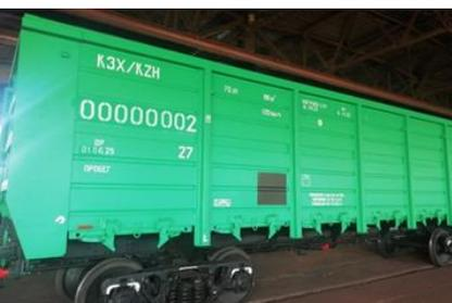
Полувагон с глухими торцевыми стенами и разгрузочными люками в полу модель **12-2153**
