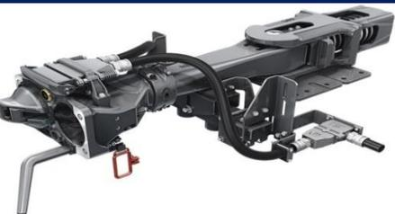
Автосцепка CargoFlex успешно прошла зимние испытания в Швеции и на горных участках в Швейцарии, а также в климатической камере центра немецкого грузового оператора DB Cargo в Миндене, полностью подтвердив работоспособность при температуре  $-40^{\circ}\text{C}$ . На европейском уровне уже [сделан](#) выбор в пользу автосцепок системы Шарфенберга для грузовых вагонов.
